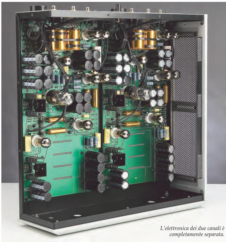
*L'elettronica dei due canali è completamente separata.*
