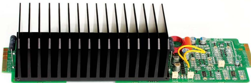
controllato dal potenziamento motorizzato posto sul frontale dell'apparecchio. Lo stadio di uscita è sviluppato a componenti discreti con tecnologia SMD. L'alimentazione della sezione pre è posta a ridosso del pannello anteriore con un trasformatore da +/- 9V e il circuito di stabilizzazione separato per i due canali. È presente anche un alimentatore monolitico realizzato da MeanWell con
