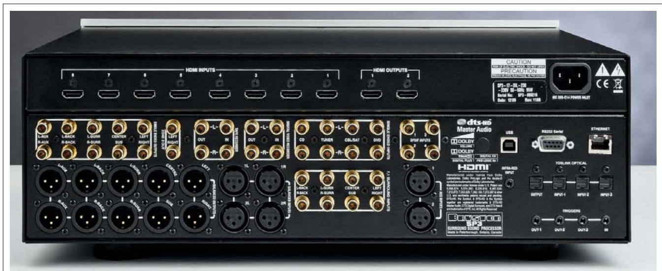
Sul pannello posteriore si nota l'elevato numero di connettori XLR bilanciati e la completa assenza di connessioni video analogiche. In compenso gli ingressi video digitali sono piuttosto numerosi, essendo disponibili otto connessioni HDMI di ingresso.
