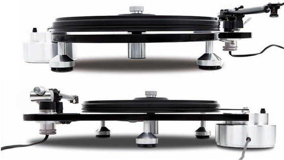
Frontalmente si possono facilmente osservare i vari componenti del giradischi messi a nudo grazie al caratteristico chassis che, come da tradizione della casa, non prevede un contenitore esterno. Si vede il telaio costituito da una tavola in acrilico sollevata da tre piedini in alluminio con un elemento cedevole alla base, sola parte preposta all'assorbimento delle vibrazioni.
