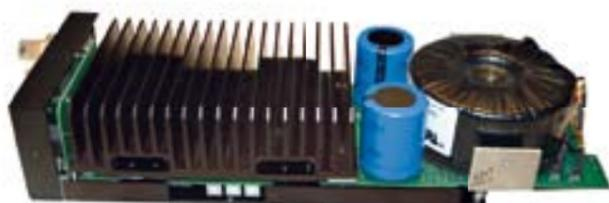
■ **MODULI DI POTENZA** - In evidenza il massiccio trasformatore toroidale costruito su specifiche Bryston e i due condensatori da 15.000 uF ciascuno. I transistor finali sono nascosti sotto il voluminoso dissipatore.
