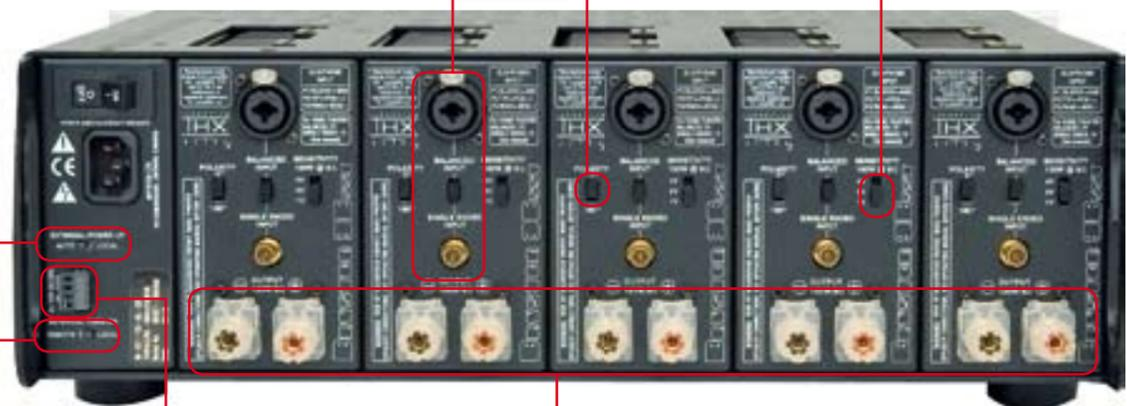
**EXTERNAL POWER UP E EXTERNAL TURN ON** - A seconda della posizione di questi switch è possibile configurare le diverse modalità di accensione del finale: insieme al preamplificatore, solo dal pannello frontale, da entrambi, ecc.
