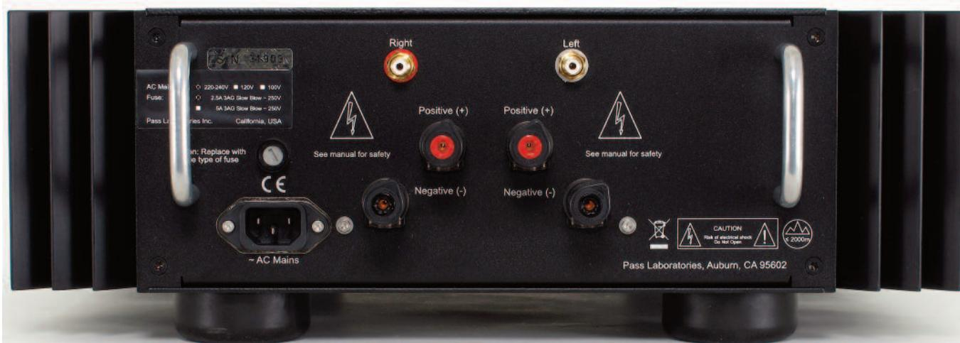
I binding post di potenza sono Furutech schermati ad alte prestazioni, possono accogliere cavo nudo o connettori fino a 4,5 mm di diametro e anche alloggiare connettori a banana. Gli ingressi sono RCA sbilanciati sempre Furutech. La vaschetta IEC ed il vano portafusibili sopra ad essa, sono posizionati a sinistra del pannello posteriore, che accoglie altresì due solide maniglie per facilitare le operazioni di allaggio di questo componente da oltre 20 chilogrammi.
